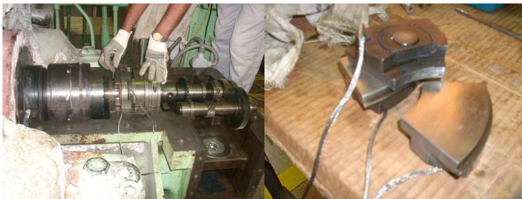
Foto 5. Instalación zapatas de empuje, sensor RTD - Turbina 2.
