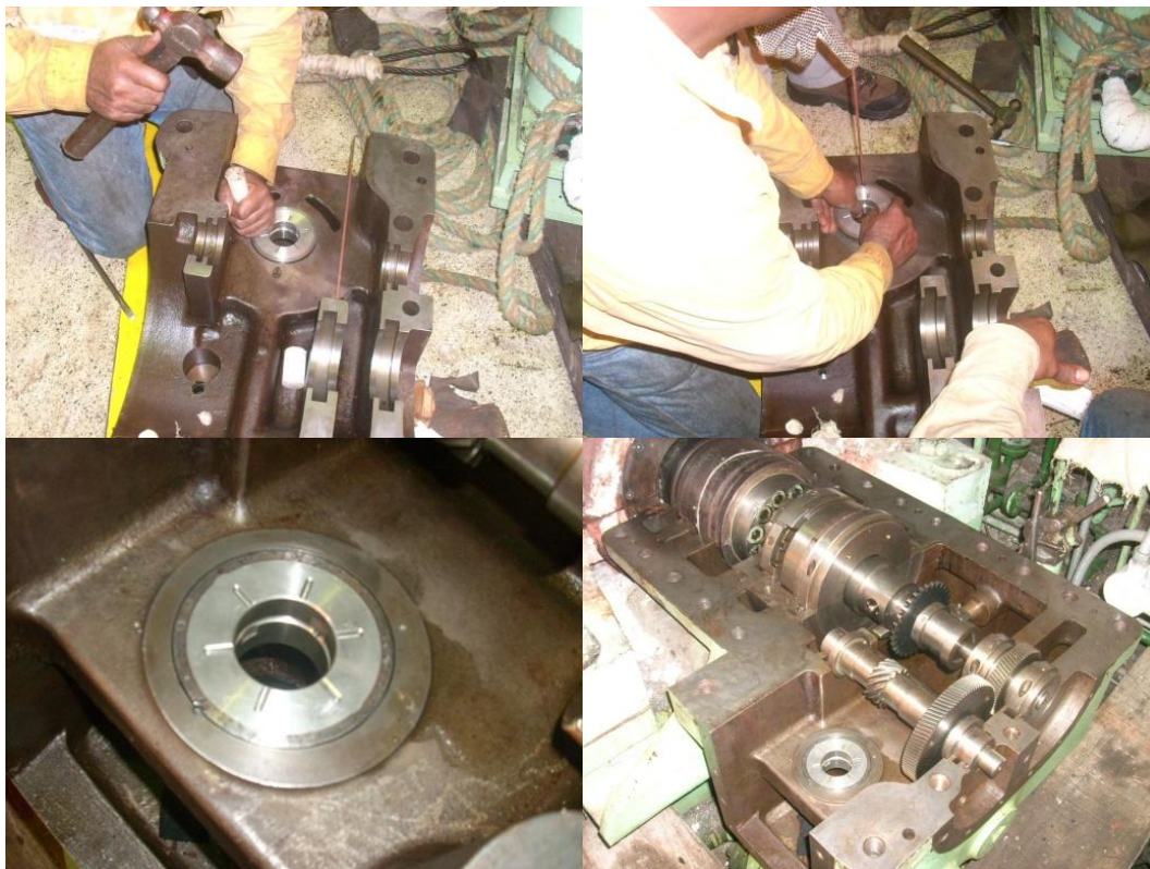
Foto 4. Instalación cojinete (tren de engranajes, mueve la bomba de lubricación turbina); cojinete parte inferior; cojinete instalado en la carcasa - Turbina 2.
