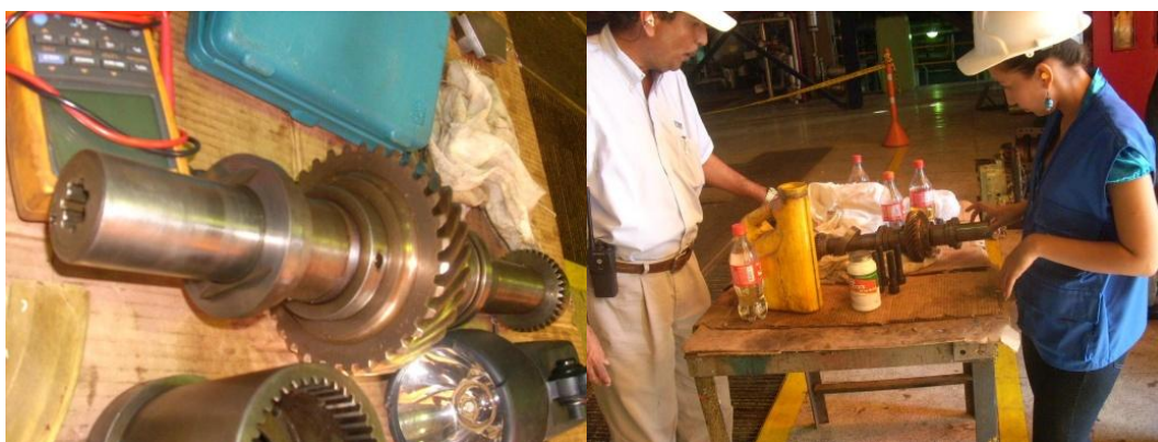
Foto 9. Tren de engranajes- acople dentado -Turbina 2.
