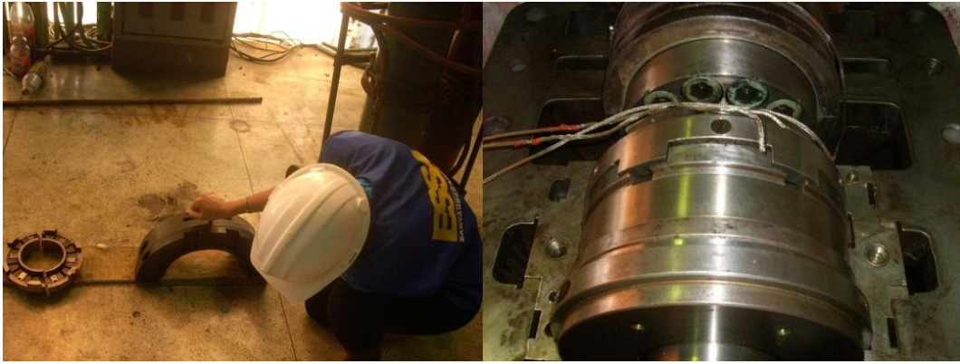
Foto 6. Porta zapata de empuje; cojinete de empuje -Turbina 2.
