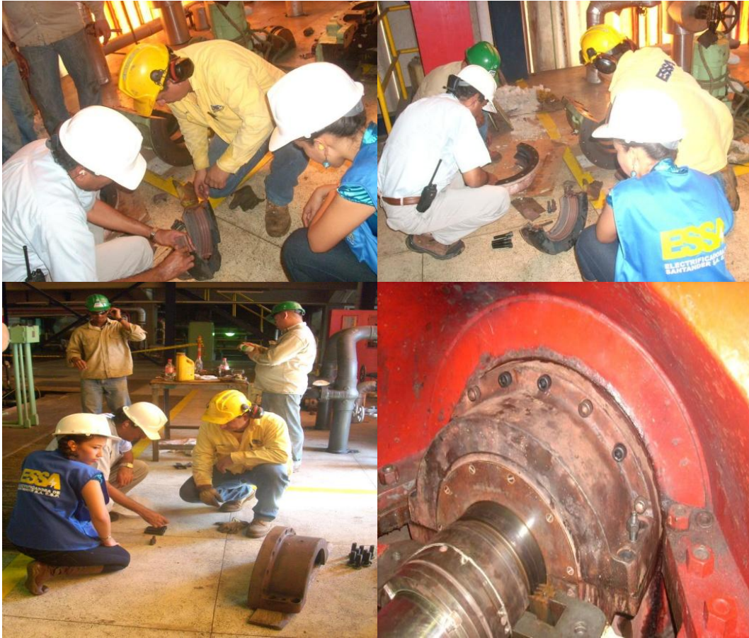
Foto 10. Sellos de vapor; caja de sellos de vapor -Turbina 2.
