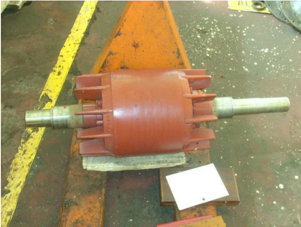
Foto 25. Rotor – Motor de la bomba 1A.
