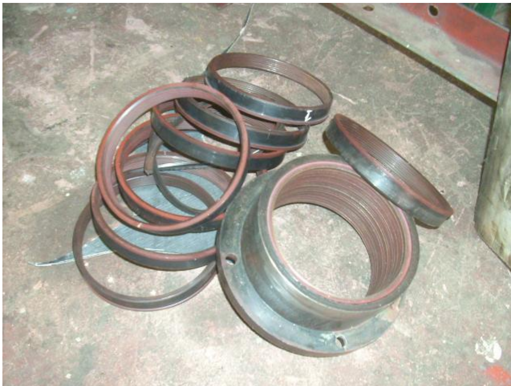
Foto 31. Piezas restituidas: Anillos de desgaste y tambor de balanceo - Bomba de alimentar caldera 1A.
