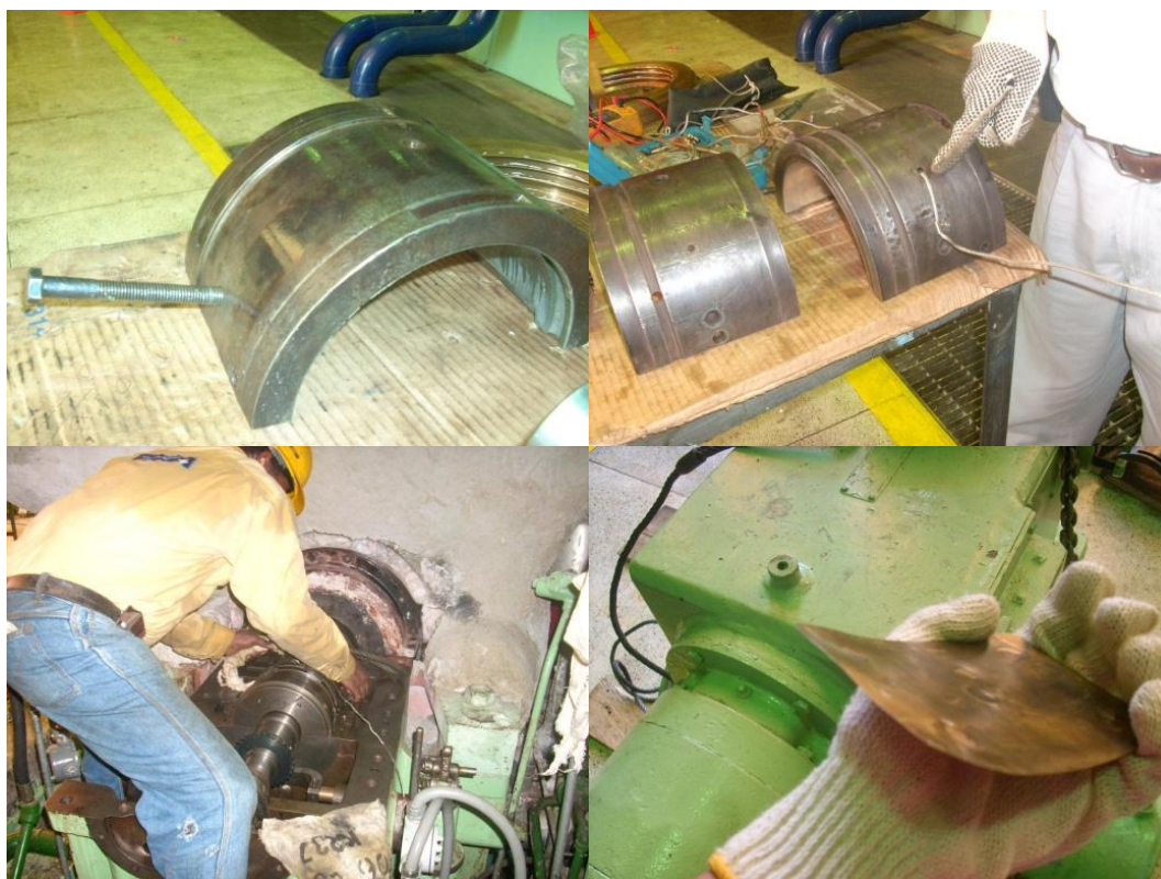
Foto 3. Mitad inferior cojinete; instalación de RTD; instalación cojinete radial, lado empuje; lámina como suplemento -Turbina 2.
