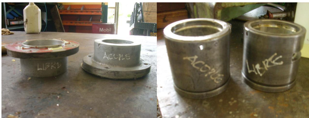
Foto 27. Sellos de aceite; cojinetes – Motor de la bomba 1A.
