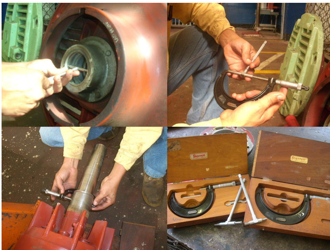
Foto 24. Mediciones para cálculo de tolerancias; micrómetros y telescópicas – Motor de la bomba 1A.
