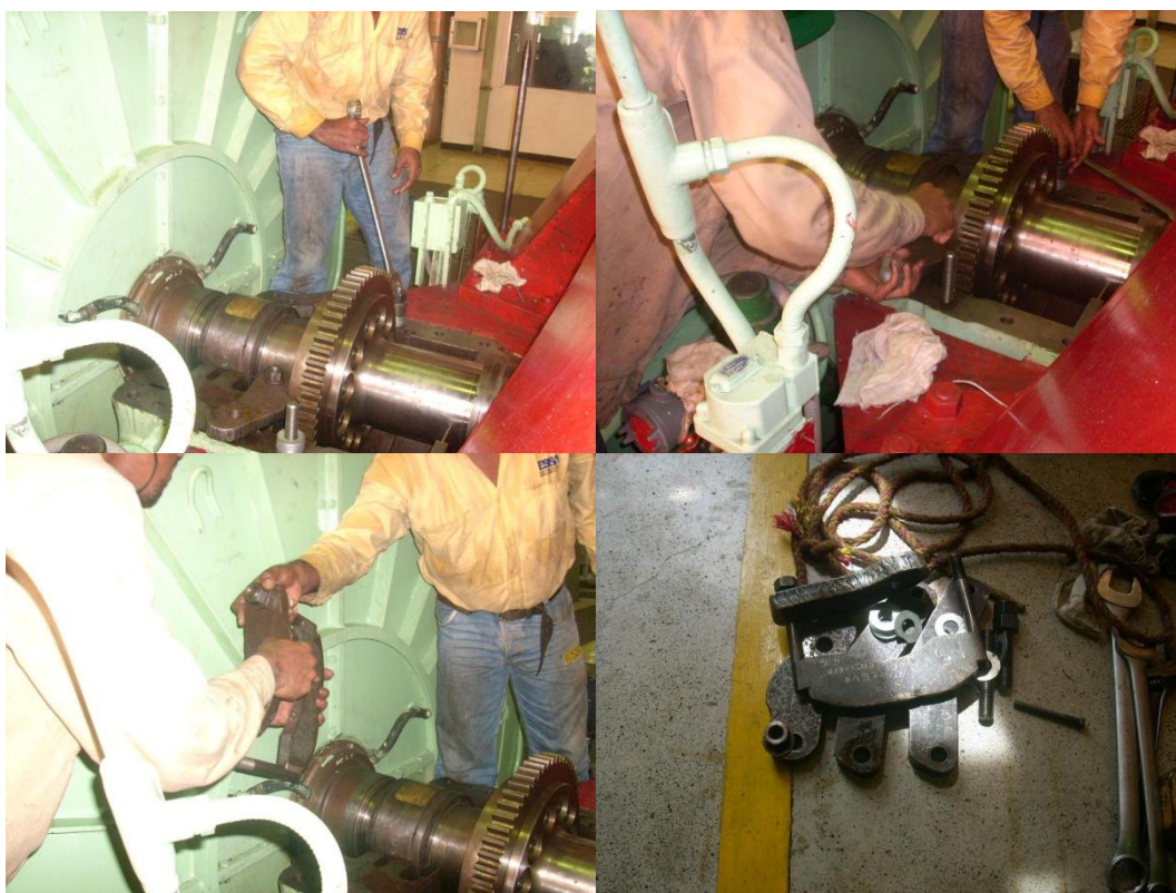
Foto 1. Soportando el eje para retirar cojinetes; levas – Turbina 2.
