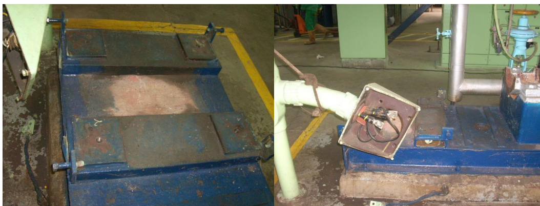
Foto 28. Base del motor, zona de trabajo; bornera destapada – Motor de la bomba 1A.
