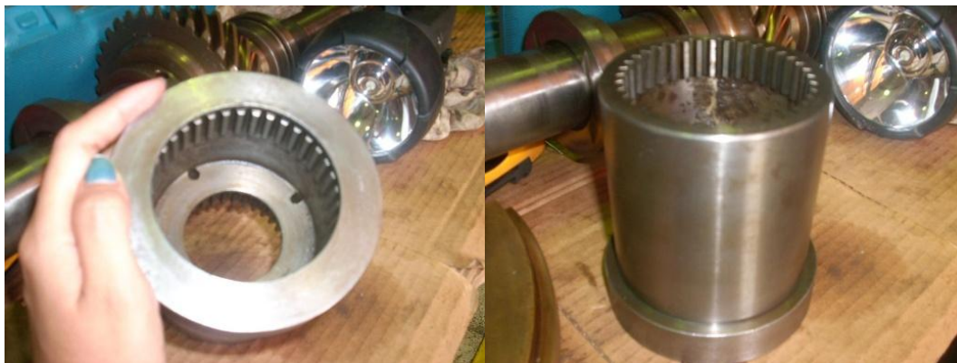
Foto 8. Acople dentado -Turbina 2.
