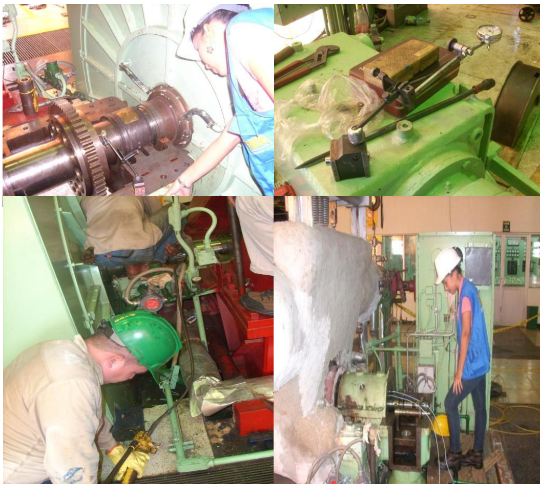
Foto 11. Comprobación desplazamiento axial con indicador de caratula, gato hidráulico, sensor desplazamiento axial-Turbina 2.
