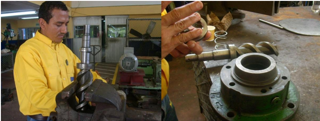
Foto 19. Eje principal o tornillo sinfin; tapa - Bomba para fuel-oil.
