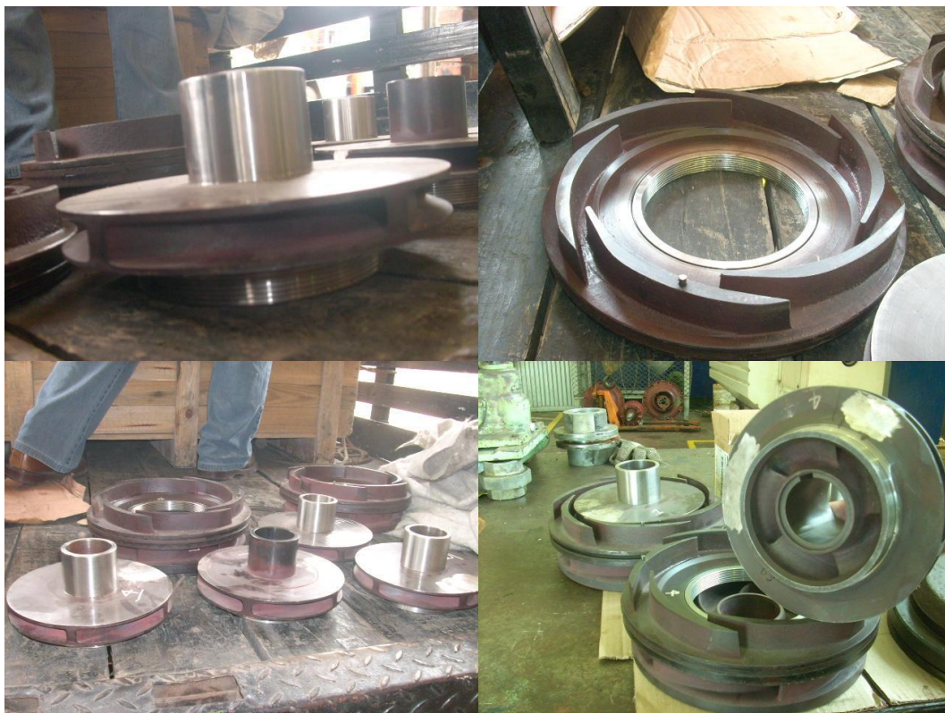
Foto 33. Impulsores y difusores - Bomba de alimentar caldera 1A.
