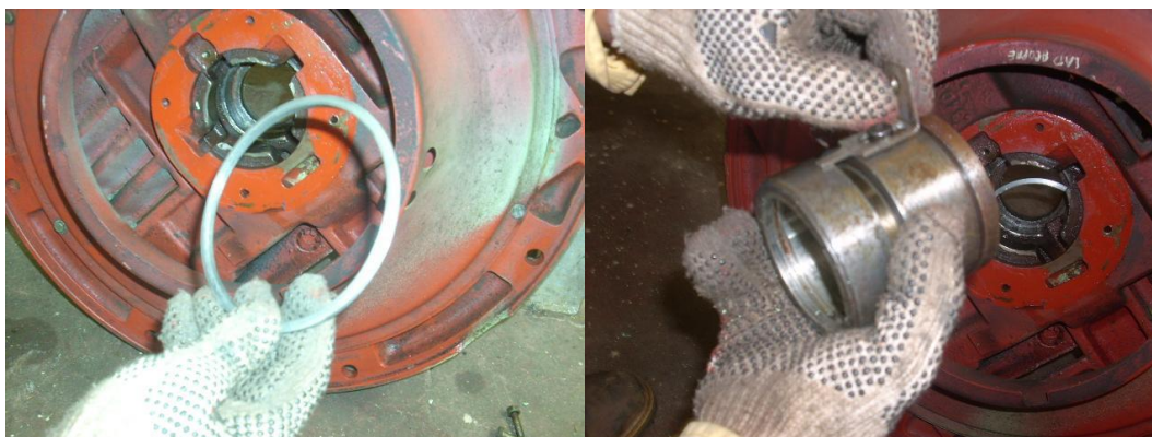
Foto 29. Anillo de lubricación; cojinete, sistema antigiro – Motor de la bomba 1A.
