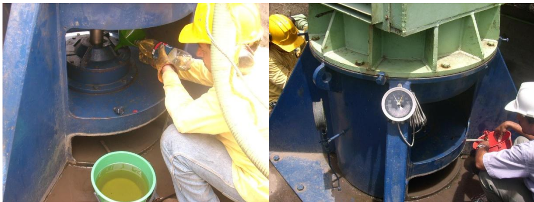
Foto 23. Cambio de aceite- Bomba vertical.
