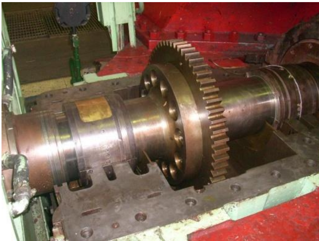
Foto 13. Eje de la turbina - Turbina 2.
