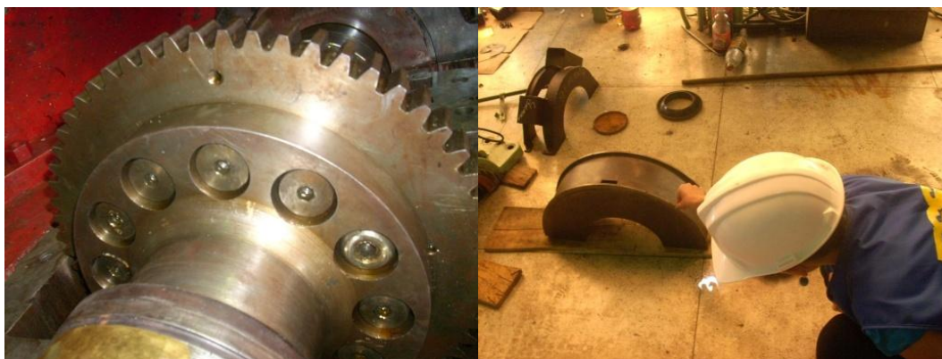
Foto 12. Piñón de engrane al virador, lado acople-brida; guarda para piñón del virador - Turbina 2.
