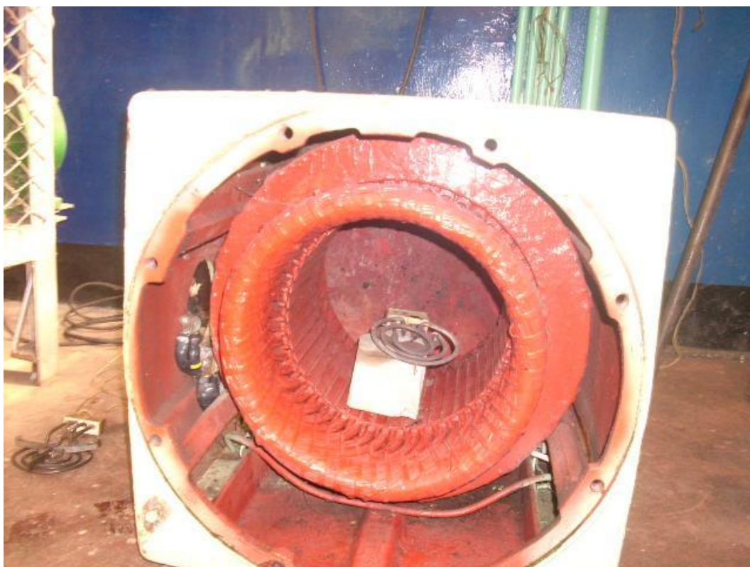
Foto 30. Estator, motor en calefacción - Motor de la bomba 1A.
